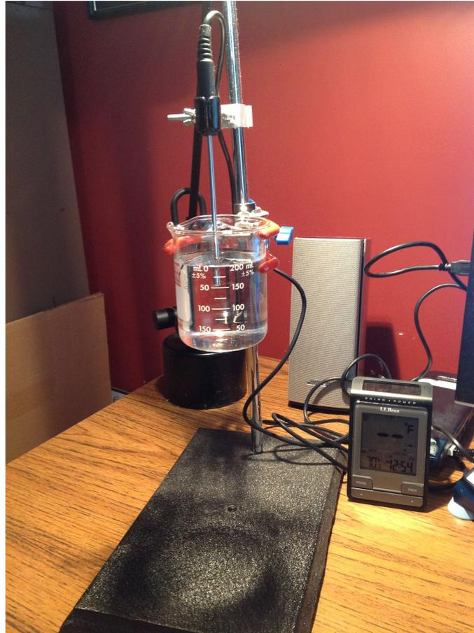
**Figura 1.** Se muestra el aparato utilizado para recopilar datos sobre el enfriamiento del agua en un vaso de precipitado. El vaso de precipitado, que contiene 200 ml de agua del grifo y la sonda térmica de acero inoxidable Vernier, se mantienen en su lugar por medio de un soporte. Un termómetro ambiental se encuentra en la esquina inferior derecha para corroborar la temperatura ambiente.
